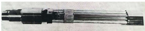
图 1 911 工程调试燃料组件
